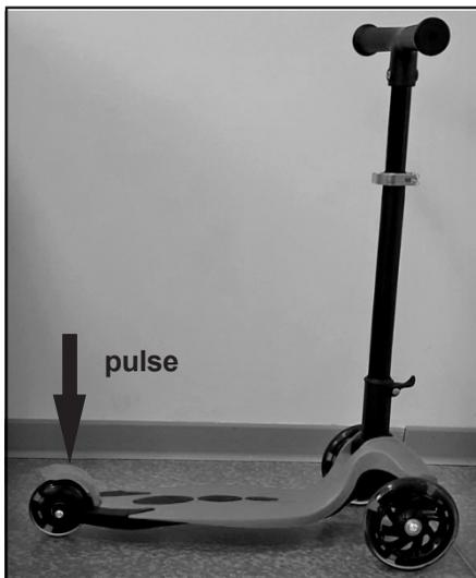
La rueda trasera tiene un FRENO. Para utilizar el freno durante el movimiento, el niño puede pisarlo con el talón y presionarlo hasta que el scooter se detenga.
