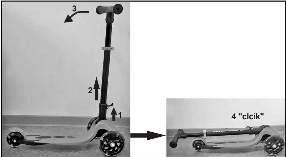
Tire de la palanca hacia arriba (1). Tire del manillar hacia arriba (2). Cierre el manillar como se muestra (3), hasta que oiga un clic (4).
