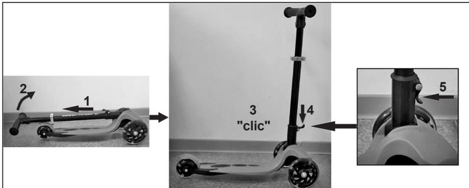
Extraiga el tubo del manillar (1) y, al mismo tiempo, gírelo hacia arriba (2), hasta que quede fijado en posición vertical y oiga un clic (3). Presione la palanca de plegado (4) hacia abajo (5), para fijar el scooter en posición desplegada.
