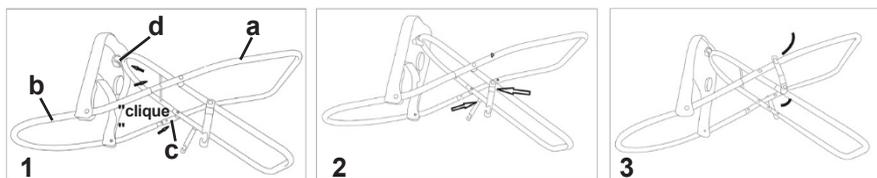
1. Colocar a parte inferior (a) da estrutura da cadeira alta na parte superior (b). Pressione até que os pinos (c) saltem para fora das ranhuras e ouve-se um clique. Fixe o tabuleiro de alimentos (d) ao tubo da cadeira com uma ligeira pressão. 2 e 3 - Rodar e pressionar os mecanismos de bloqueio (e) para fixar a cadeira
